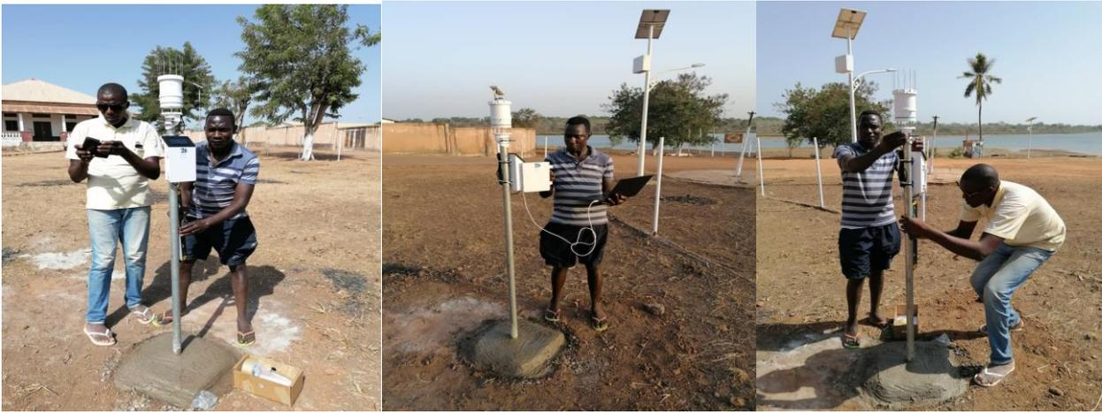
**Figura-3.** Montagem de estação meteorológica em Buba, ATMOS 41, registrador z6-10699
