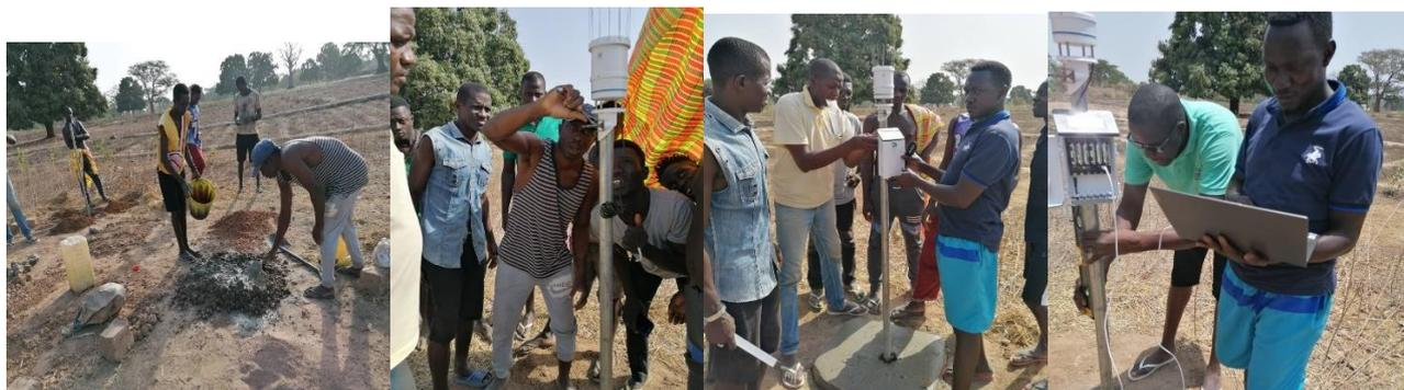
**Figura-5.** Montagem de estação meteorológica em N´tchugal, ATMOS 41, registador Z6- 10708
