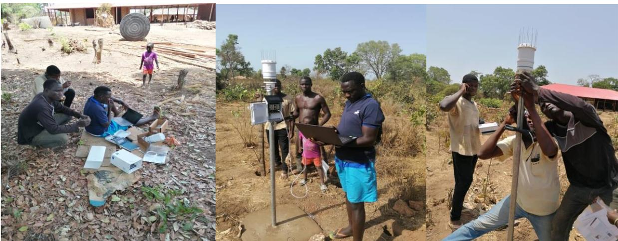
**Figura-4.** Montagem de estação meteorológica em Malafu-1, ATMOS 41, registrador z6-10706
