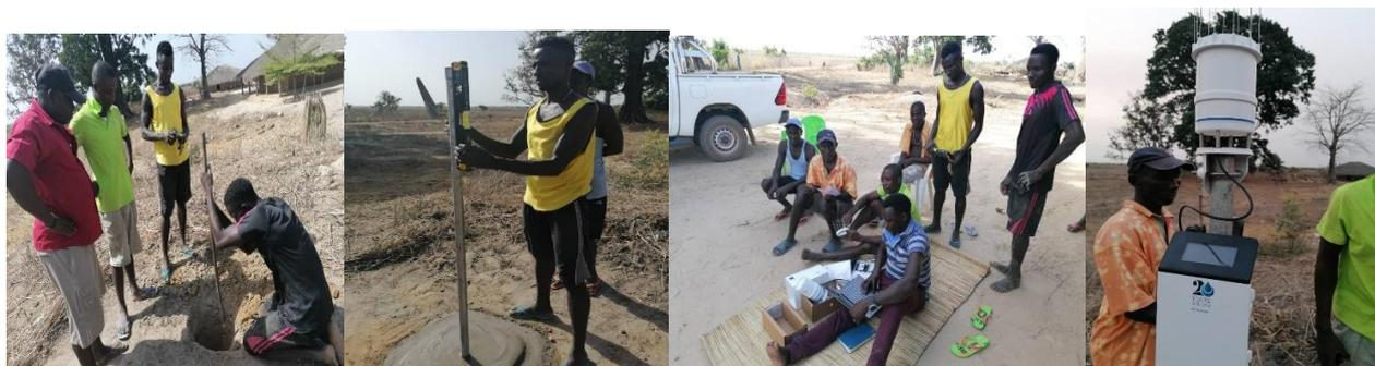
**Figura-2.** Montagem de estação meteorológica em Cafine, ATMOS41, registador z6-10711
