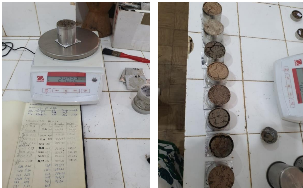
Figura 9: (a) Pesagem do cilindro depois de secagem; (b) diferentes cilindros usados para a densidad aparente.
