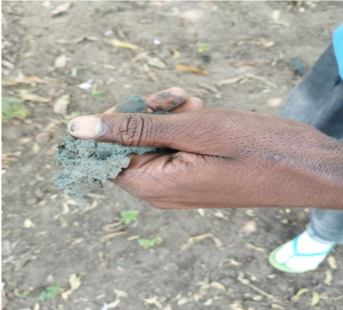
Figura 2 - Determinação da textura por método de tato
