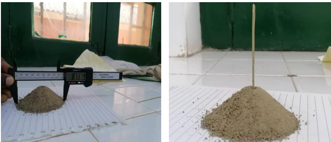
Figura 9 - Medição do ângulo de repouso, e matérias utilizados Fonte: Própria, 2023
